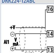
**Per segnali normalizzati in corrente e tensione.**
