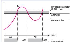
Allarme di deviazione inferiore valore di setpoint allarme minore di "0" e valore di isteresi maggiore di "0" (Par. 128 R.I.HY > 0). Con isteresi minore di "0" (R.I.HY < 0) la linea tratteggiata si sposta sotto il Setpoint di allarme.
