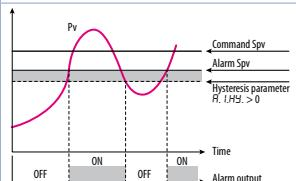
Allarme di deviazione superiore valore di setpoint allarme minore di "0" e valore di isteresi maggiore di "0" (Par. 128 R.I.HS > 0).
