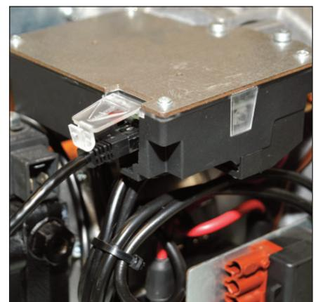
**!** Het instrument heeft een kabel en RJ45-connector die uitsluitend mogen worden verbonden met Ecoflam eentraps gas- en gasoliebranders die zijn uitgerust met de apparatuur E-BCU Thermowatt die voorzien is van een RJ45-verbinding. Alvorens het instrument aan en af te koppelen moet de elektrische spanning van de brander worden weggenomen, om persoonlijk letsel of materiële schade te vermijden.
