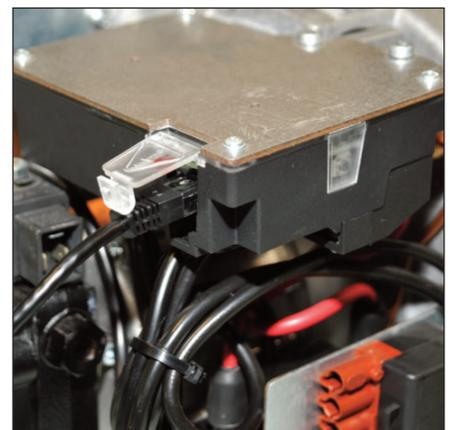
**!** La herramienta está provista de cable y conector RJ45 para conectar exclusivamente a quemadores Ecogram monoestadio gas y gasóleo dotados de aparatos E-BCU Thermowatt con conexión RJ45. Antes de conectar o desconectar la herramienta desconectar la corriente eléctrica del quemador para evitar daños a personas o cosas.
